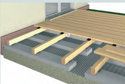
1. Anschließend alle weiteren Dielen zusammen mit den Abstandhaltern auf der Unterkonstruktion fixieren.
